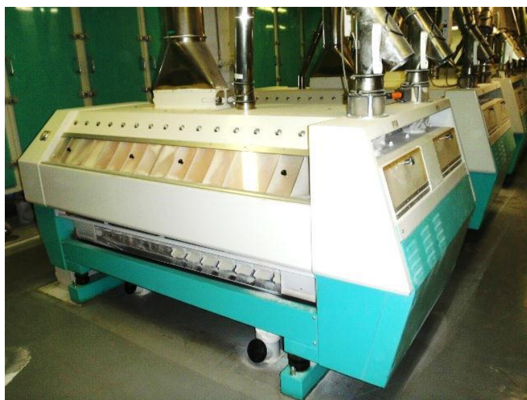
千葉製粉Cミル工場5階フロアのピュリファイヤー。合計8台が24時間稼働しています。
