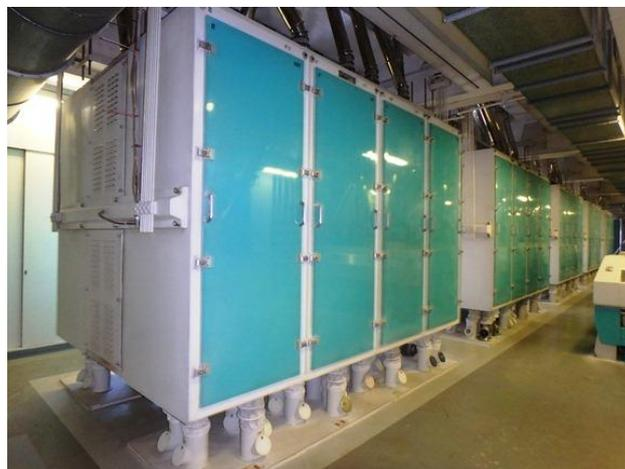
千葉製粉Cミル工場5階フロアでは、合計5台・40ボックスのシフターが24時間稼働しています。
