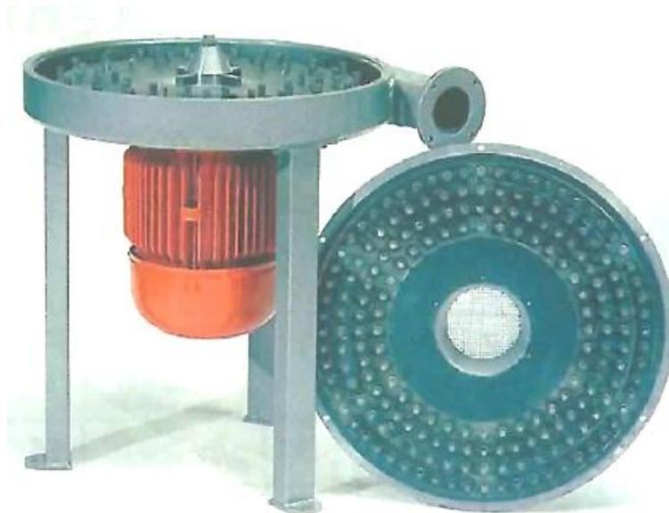
インパクトデタッチャー内部構造の様子。円盤上下に取り付けられた金属製のピンが高速で回転し、フレークを「解きほぐす」役割を果たす。
