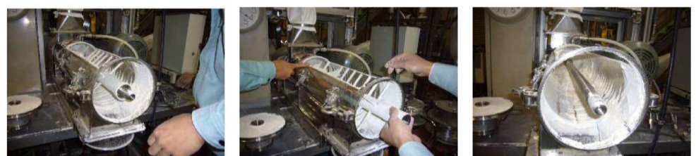
本体内部 (内部は清掃容易な構造)
