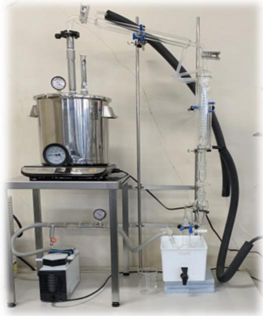
【15L 水蒸気蒸留器】
